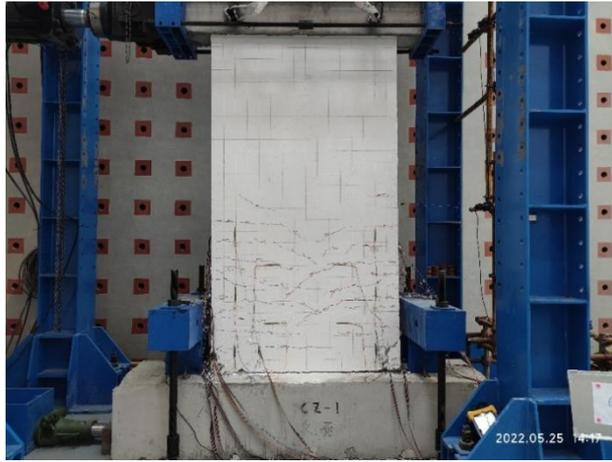
图11 墙模侧剪力墙试件破坏图
